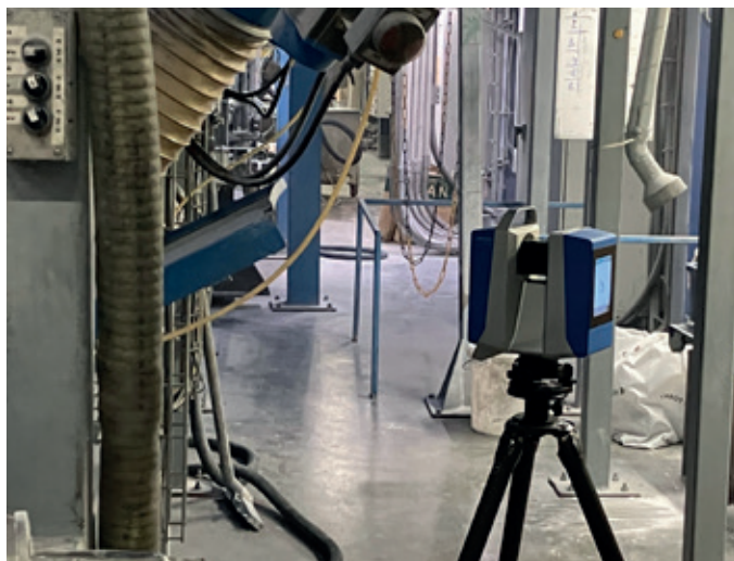
Här har 3D-lasern satts upp. Redo att börja mäta.
